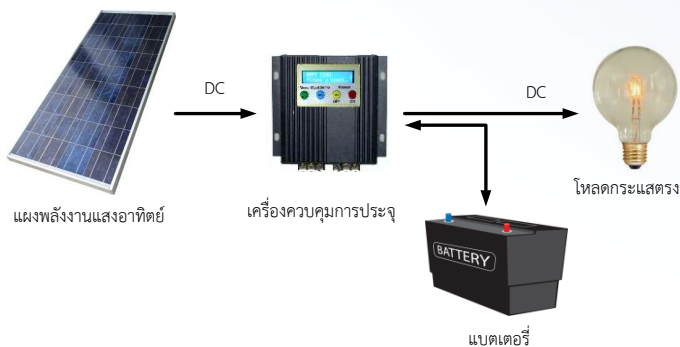
รูปที่ 3.33 แผงเซลล์แสงอาทิตย์ที่มีเครื่องควบคุมการประจุให้กับแบตเตอรี่ซึ่งจ่ายไฟให้กับโคมไฟกระแสดตรง
