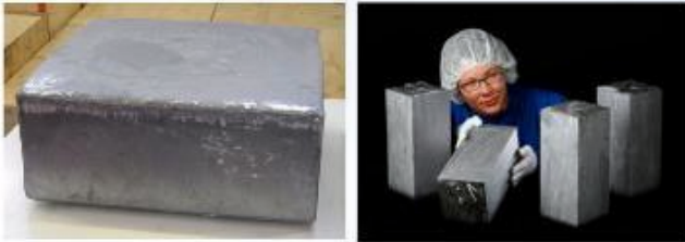
รูปที่ 3.11 ก้อนโพลีคริสตัลไลน์และการเลื่อยเป็นบล็อกสี่เหลี่ยม
