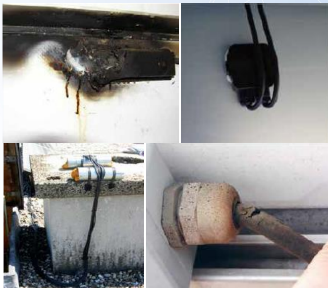
รูปที่ 5.19 ตัวอย่างการเสียหายที่เกิดขึ้นที่สายไฟของระบบแผงเซลล์แสงอาทิตย์
